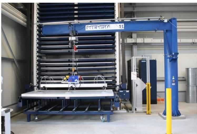
WEWIRA Säulenschwenkkran WSH. Der Kran hat einen Schwenkradius von 270° und bietet eine Ausladung von bis zu 7.000 mm. Link > [WSH](#)
