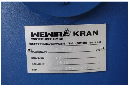
Für die letzte Neubaustufe waren Laufkrane mit einer Traglast von 5.000 kg ausreichend. An den Maschinen ergänzen Schwenkkrane vom Typ WSH den Arbeitsplatz mit einer Tragkraft von 1.000 kg und arbeiten unterhalb der Laufkrane. Als Lastaufnahme für die Bleche dient ein Vakuumheber.
